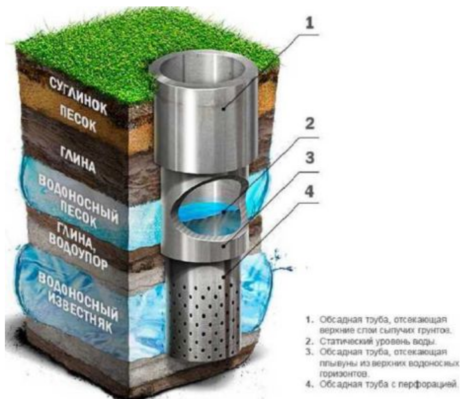
Рисунок 4.1. Конструкция артезианской скважины
